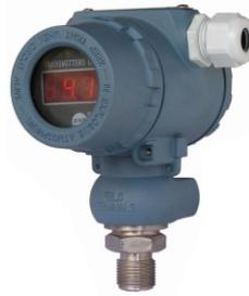
PAC压力变送器内置进口扩散硅芯体传感器。易安装，可选配LED显示表头。适用于气体和液体介质的表压、绝压和负压测量。广泛应用于石油、化工、冶金、电力、水文等行业的压力测量。
